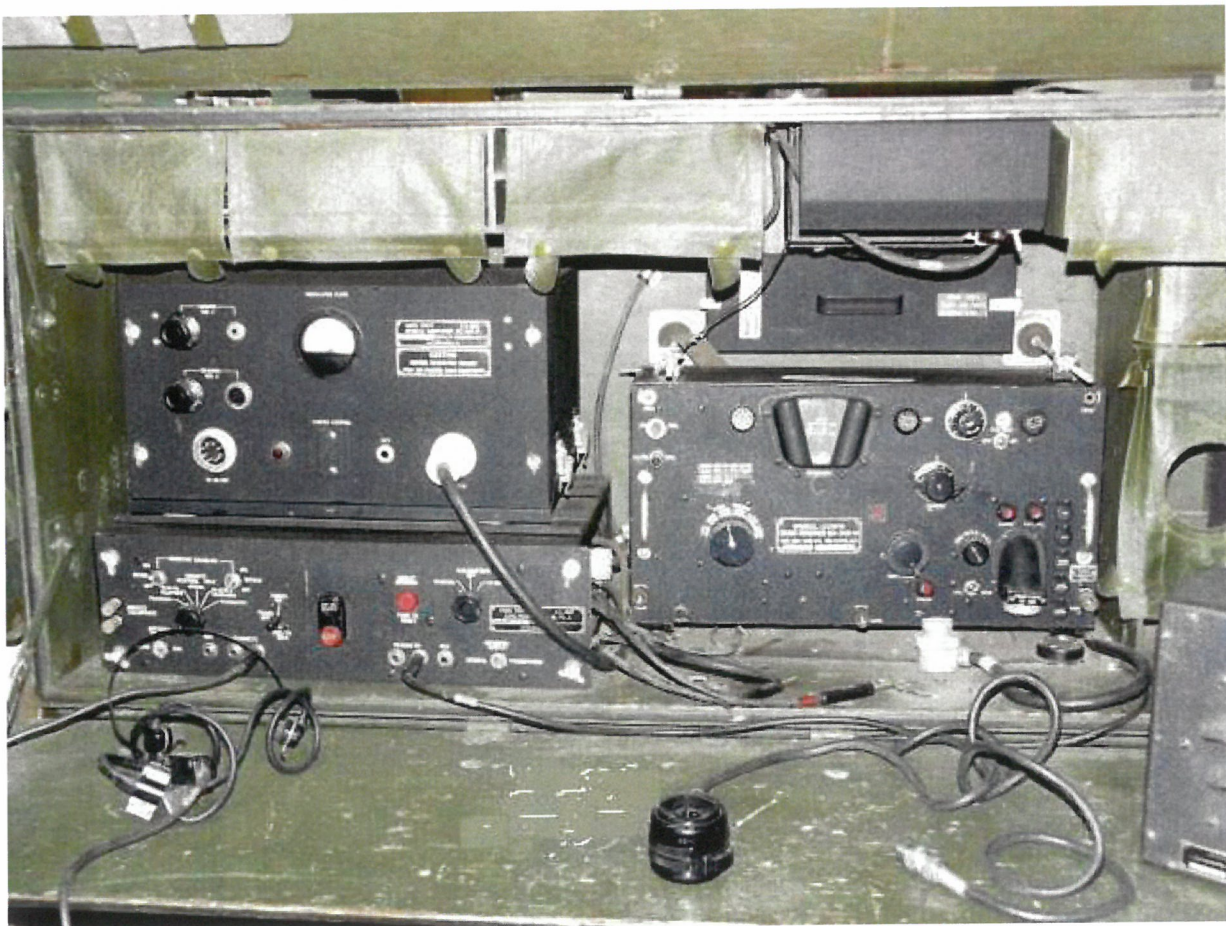
Poste opérateur du SCR 399 Poste HF modulation d'amplitude Récepteur : BC 342, Ampli BF pour émetteur : BC 614, Boite de jonction : JB 70A
