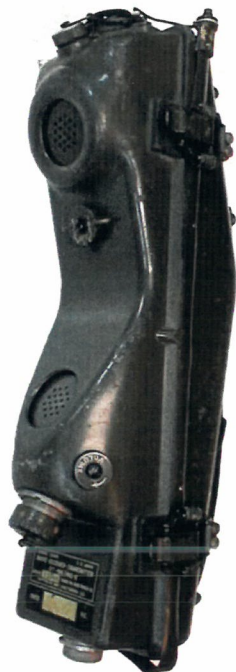
AN/PRC 6 ER portable Modulation de Fré- quence. Gamme 47 à 55,4 Mhz. 1 canal préréglé Puissance : 0,5w Alimentation : Batt BA270/U
