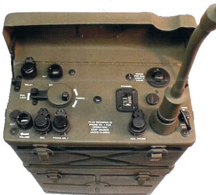
SCR 300 Emetteur-récepteur BC1000 VHF. Modulation de Fréquence. Gamme de fréquen- ce : 40 à 48 Mhz. Puissance 0,3 watts. Alimenté par batterie BA 70 (pds 3kg) Antennes AN130 et AN 131. Combiné TS15
