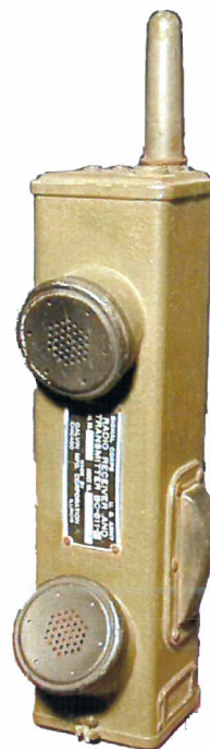
SCR 536 Gamme de Fréquence : 3,5 à 6Mhz Puissance : 0,36w Portée : 1600m Alimentation : BA 37 et BA 38 Poids en ordre de marche : 2,5 kg
