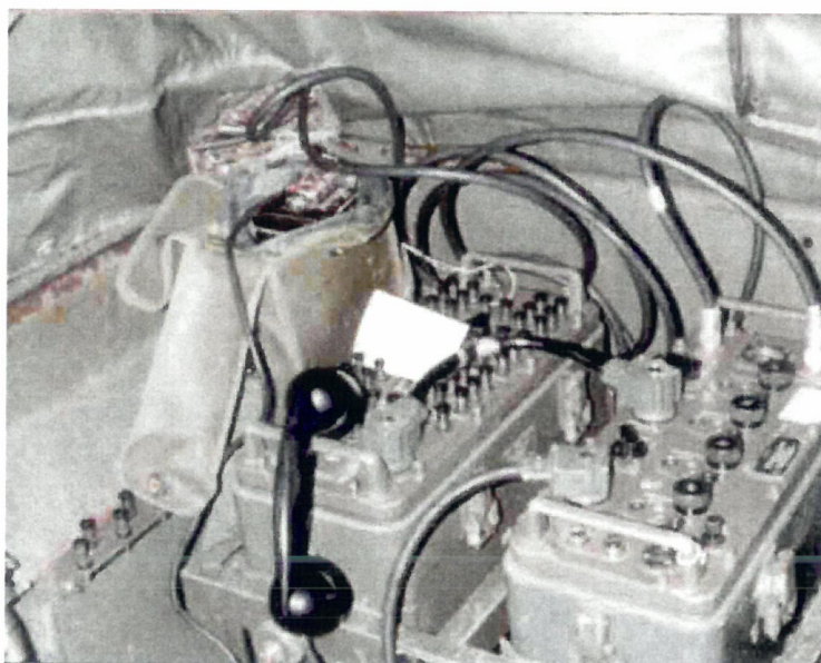
QRTH 1A Câble hertzien léger à 3 voies téléphoniques. Gamme de Fréquence : 1700 à 2000 Mhz en Mo- dulation par Impulsions Puissance HF 0,4 w Alimentation : 110/220v 50hz
