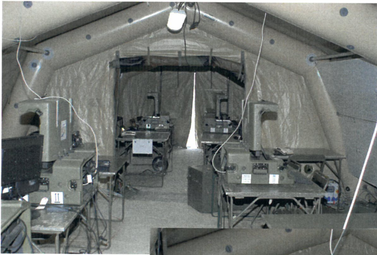
Centre opérations (Version lourd) 150 m 2 . On remarque que les tentes sont « gonflables » donc montées très rapidement.
