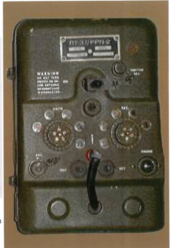
Balise EUREKA - REBECCA Emetteur récepteur RT-37/PPN2 Interrogée par les avions en vol, la balise répond par l'émission d'un code qui identifie la zone de largage.
